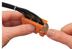
Encaixe a trava de segurança do conector lateral no suporte de montagem.
