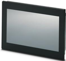
Painel tátil com TFT de 25,7 cm/10,1"-display (analógica e resistiva), 1024 x 600 pixel (WSVGA), 16,7 milhões de cores, Arm<sup>®</sup> Cortex<sup>®</sup>-A7, 528 MHz i.MX6 UL, 2x COM (RS-232/422/485), 1x USB 2.0, Typ A, 1x USB 2.0, Typ B, 1x Ethernet (10/100 MBit/s), RJ45, Windows<sup>®</sup> Embedded Compact 7 e software do usuário: Visu+. (sistema Bus: sem)
