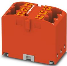
Bloco de distribuição, Borne básico, tensão nominal: 450 V, corrente nominal: 24 A, quantidade de conexões: 6, tipo de conexão: Conexão Push-in, perfil de conexão: 0,14 mm<sup>2</sup> - 4 mm<sup>2</sup>, tipo de montagem: encaixar no adaptador de trilho de fixação, Montagem direta com flange, Suspensão, cor: vermelho
