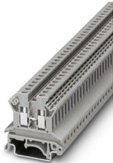
Borne de passagem, tensão nominal: 800 V, corrente nominal: 24 A, quantidade de conexões: 2, tipo de conexão: Conexão a parafuso, Bitola: 2,5 mm<sup>2</sup>, perfil de conexão: 0,2 mm<sup>2</sup> - 4 mm<sup>2</sup>, tipo de montagem: NS 35/7,5, NS 35/15, NS 32, cor: cinza
