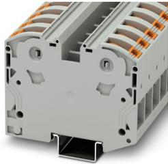
Terminal de alta corrente, tensão nominal: 1000 V, corrente nominal: 125 A, quantidade de conexões: 2, tipo de conexão: Conexão PowerTurn, Bitola: 35 mm<sup>2</sup>, perfil de conexão: 2,5 mm<sup>2</sup> - 35 mm<sup>2</sup>, tipo de montagem: NS 35/15, cor: cinza
