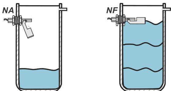
\*A chave permanece no estado inicial ( NA ) até o nível da água atingir o nível máximo, neste ponto o contato interno da chave altera de NA para NF.
