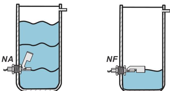
\*A chave permanece no estado inicial ( NA ) enquanto o nível de água estiver acima dela. Assim que a água atingir o nível mínimo, o contato interno muda de NA para NF..
