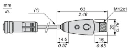
(1) Cabo, comprimento: 152 mm.
