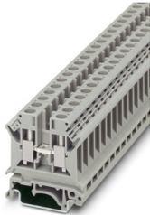
Borne de passagem, tensão nominal: 800 V, corrente nominal: 41 A, quantidade de conexões: 2, tipo de conexão: Conexão a parafuso, Bitola: 6 mm<sup>2</sup>, perfil de conexão: 0,2 mm<sup>2</sup> - 10 mm<sup>2</sup>, tipo de montagem: NS 35/7,5, NS 35/15, NS 32, cor: cinza
