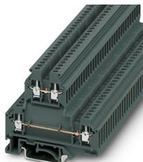
Borne de vários andares, níveis superior e inferior jumpeáveis, tensão nominal: 500 V, corrente nominal: 21 A, tipo de conexão: Conexão a parafuso, Bitola: 2,5 mm<sup>2</sup>, perfil de conexão: 0,5 mm<sup>2</sup> - 4 mm<sup>2</sup>, tipo de montagem: NS 35/7,5, NS 35/15, NS 32, cor: cinza escuro
