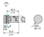
e Espessura do painel de suporte: de 1 a 6 mm/de 0,4 a 0,24 pol. (metal), de 2 a 6 mm/de 0,8 a 0,24 pol. (plástico).
