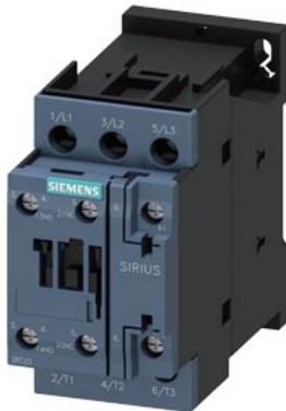
Contator de potência, CA-3 25 A, 11 kW / 400 V 1 NA + 1 NF, 220 V CA, 60 Hz, de 3 polos, tamanho S0 conexão parafusada
