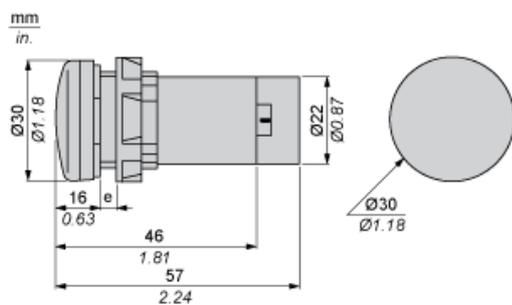
e Espessura do painel de suporte: de 1 a 6 mm/de 0,4 a 0,24 pol. (metal), de 2 a 6 mm/de 0,8 a 0,24 pol. (plástico).
