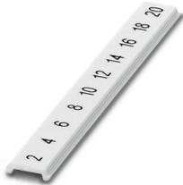
Tira Zack plana, Fitas, branco, identificado, impresso horizontalmente: números pares consecutivos 2 ... 20, 22 ... 40, etc. até 82 ... 100, tipo de montagem: travamento, para a largura de terminal: 5 mm, tamanho para gravação: 5,15 x 5,15 mm, Quantidade de plaquetas de identificação: 10
