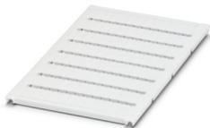
Marcador de terminais, Folha, branco, não impresso, identificável com: BLUEMARK ID COLOR, BLUEMARK ID, BLUEMARK CLED, PLOTMARK, CMS-P1-PLOTTER, tipo de montagem: travamento, para a largura de terminal: 5,2 mm, tamanho para gravação: 4,6 x 10,5 mm, Quantidade de plaquetas de identificação: 96
