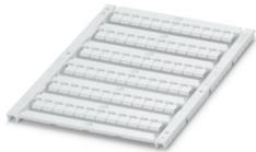
Marcador de terminais, Folha, branco, não impresso, identificável com: TOPMARK NEO, TOPMARK LASER, BLUEMARK ID COLOR, BLUEMARK ID, BLUEMARK CLED, THERMOMARK PRIME, THERMOMARK CARD 2.0, THERMOMARK CARD, tipo de montagem: travamento, para a largura de terminal: 5,2 mm, tamanho para gravação: 4,4 x 4,7 mm, Quantidade de plaquetas de identificação: 72
