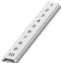
Tira Zack plana, Fitas, branco, identificado, impressão vertical: números consecutivos 1 ... 10, 11 ... 20 etc. até 91 ... 100, tipo de montagem: travamento, para a largura de terminal: 5 mm, tamanho para gravação: 5,15 x 5,15 mm, Quantidade de plaquetas de identificação: 10
