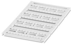
Marcador de terminais, Folha, branco, não impresso, identificável com: BLUEMARK ID COLOR, BLUEMARK ID, BLUEMARK CLED, PLOTMARK, CMS-P1-PLOTTER, tipo de montagem: travamento, para a largura de terminal: 5,2 mm, tamanho para gravação: 4,6 x 5,1 mm, Quantidade de plaquetas de identificação: 96
