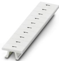
Tiras de identificação Zack, Fitas, branco, identificado, identificável com: CMS-P1-PLOTTER, impresso horizontalmente: números iguais 1 ou 2 etc. até 100, tipo de montagem: travamento, para a largura de terminal: 5,2 mm, tamanho para gravação: 5,15 x 10,5 mm, Quantidade de plaquetas de identificação: 10
