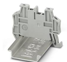
Suporte terminal para montagem rápida, para trilho de fixação NS 35/7,5 ou trilho de fixação NS 35/15, com possibilidade de marcação, com possibilidade de fixação para FBS...5, FBS...6, KSS 5, KSS 6, largura: 5,15 mm, cor: cinza
