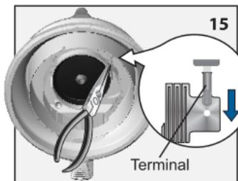
• **Desencaixe os terminais da resistência dos pinos do corpo do produto, utilizando um alicate de bico (Fig.:15).**
