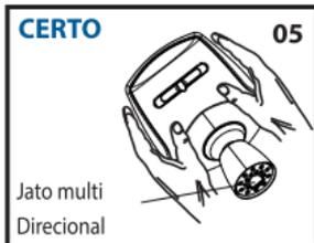
● Instale a Ducha girando-a suavemente sem usar ferramentas (Fig.:05).
