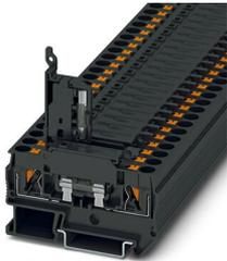
Bornes fusíveis, tipo de fusível: Vidro/cerâmica/..., tipo de fusível: G / 5 x 20, tensão nominal: 500 V, corrente nominal: 6,3 A, tipo de conexão: Conexão Push-in, 1. nível, Bitola: 1 mm<sup>2</sup>, bitola: 0,2 mm<sup>2</sup>- 6 mm<sup>2</sup>, tipo de montagem: NS 35/7,5, NS 35/15, cor: preto
