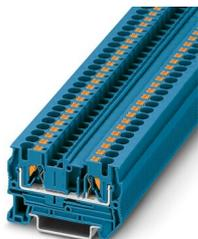
Borne de passagem, tensão nominal: 800 V, corrente nominal: 32 A, quantidade de conexões: 2, tipo de conexão: Conexão Push-in, Bitola: 4 mm<sup>2</sup>, perfil de conexão: 0,2 mm<sup>2</sup> - 6 mm<sup>2</sup>, tipo de montagem: NS 35/7,5, NS 35/15, cor: azul
