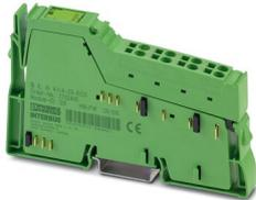
Inline, Terminal de entrada analógica, Entradas analógicas: 4, 4 mA ... 20 mA, tecnologia de conexão: 2 condutores, velocidade de transmissão no bus local: 500 kBit/s, grau de proteção: IP20, incluindo conector Inline
